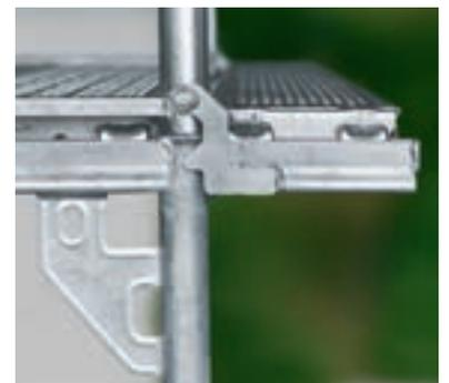
Geniale Lösung: die Layher Steckkonsole zur schnellen Gerüstinnenverbreiterung. Während herkömmliche Konsolen mit Halbkupplungen festgeschraubt und ausgerichtet werden müssen, wird die Steckkonsole lediglich in das vorhandene Fallsteckerloch eingesteckt.
