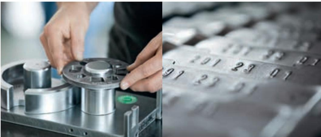
Genauso selbstverständlich wie strenge Qualitätskontrollen in jeder Produktionsphase ist für uns die Kennzeichnung und Dokumentation aller Teile. So erhält zum Beispiel jeder Layher Boden am Ende des Produktionsprozesses eine Prägung, die Auskunft über Maschine, Herstellungstag und verschiedene Produktionsparameter gibt.
