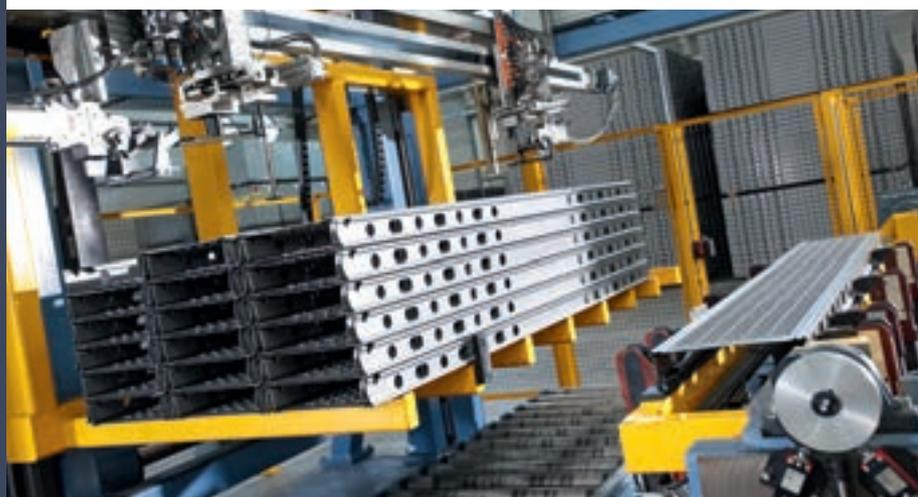
Das Stahlband wird in der Exzenterpresse gelocht und mit einem Formwerkzeug auf Länge geschnitten. Daran schließt sich eine Profilieranlage an, in der die Platine auf einer Strecke von circa 15 Metern zum Kastenprofil geformt wird. Der nahezu fertige Stahlboden wird automatisch abgestapelt. In der nachfolgenden Schweißanlage werden schließlich die Kappen mit den Auflagekrallen in das Kastenprofil eingeschweißt.
