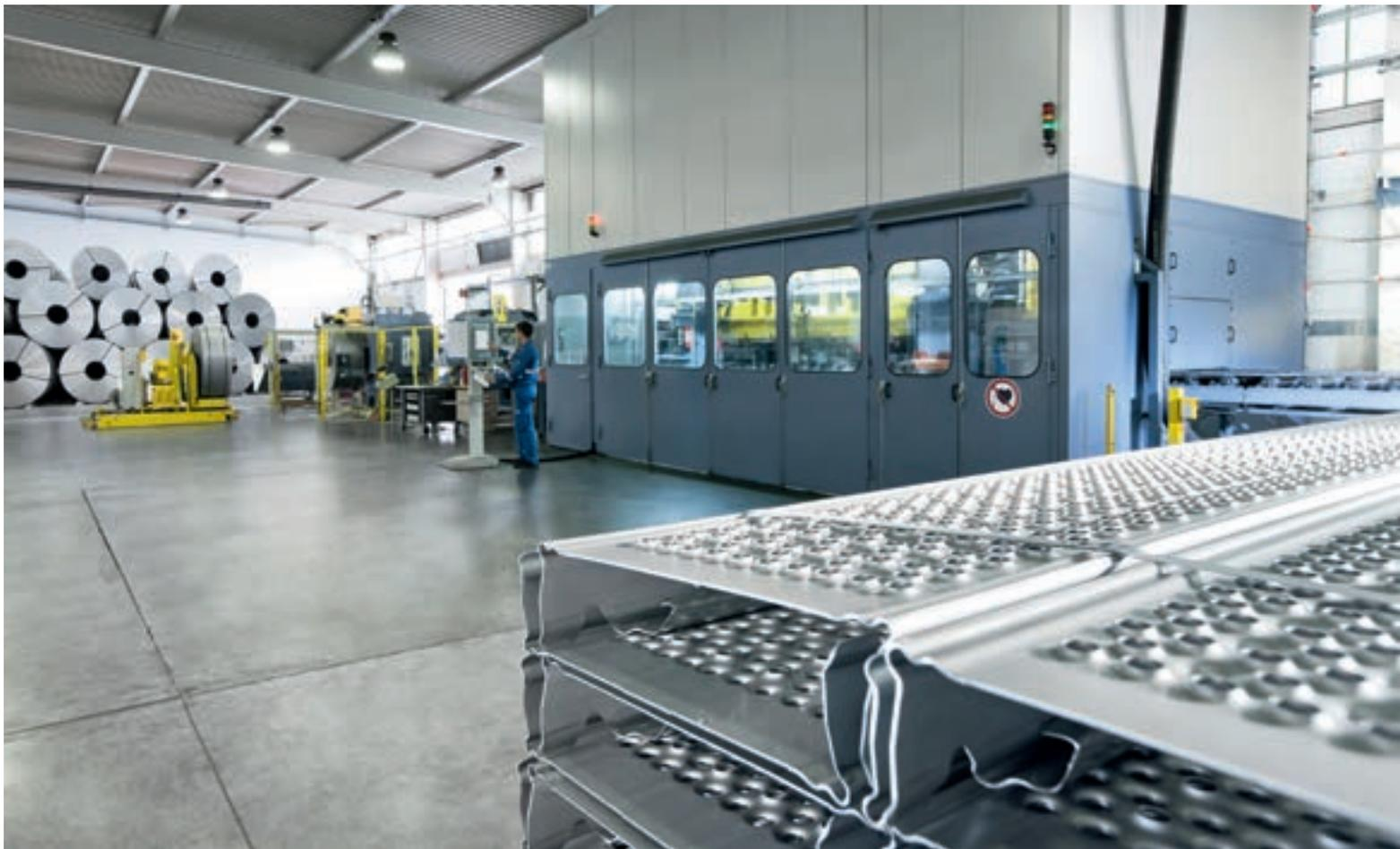
Layher Stahlböden werden aus bis zu 11 Tonnen schweren und 1,7 Kilometer langen Stahlbändern gefertigt. Die so genannten Endlos-Coils werden mit einer Krananlage und einem Ladewagen in eine Haspel gesetzt, von wo aus das Stahlband über eine Richtmaschine einer 650 Tonnen starken Exzenterpresse zugeführt wird.
