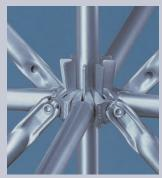
Bis zu 8 Anschlüsse lassen sich im statisch idealen Allround-Knoten auf einer Ebene in verschiedenen Winkeln anschlagen. Anschlagmöglichkeiten sind im Rastermaß von 50 cm an allen Allround-Stielen vorgesehen. Die flache Lochscheibe verhindert ein Zusetzen mit Schmutz aller Art.
