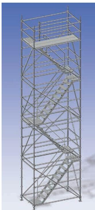
Der modulare Gerüsttreppenturm ist die perfekte Lösung für Baugruben, Rohbauten, Baustellenzugänge zu Schalungen und vielem mehr. Dank des 2,21-m-langen Allround Stiels verfügt der Treppenturm über keine stoßübergreifende Bauteile und kann Etage für Etage am Boden vormontiert und per Kran aufgesetzt werden.
