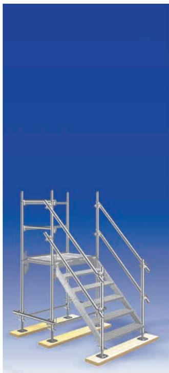
Mit der Layher Modultreppe werden stets passende, systemkonforme Aufstiege erstellt. Durch einfaches Zusammenstecken der einzelnen Treppenteile ist jedes Zwischenmaß ohne Basteleien erreichbar. Die Treppe steigt von Stufe zu Stufe um 20 cm; oben liegt das Anfangsstück bündig mit dem Boden des Treppenturms, unten nimmt das Endstück mit Gerüst-Spindeln die Feinnivellierung vor.
