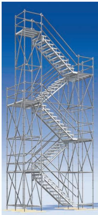
Beim Allround-Bautreppenturm 200, 12-stielig, werden die Treppen jeweils aus 2 separaten U-Treppenwangen 200 und Serienböden als Stufen zusammengesetzt. So sind zum einen Gewicht bzw. Volumen der Einzelteile geringer, Anteile an Serienmaterial höher und Zusatzkosten niedriger, zum anderen sind noch mehr Varianten der Treppenbreiten möglich.
