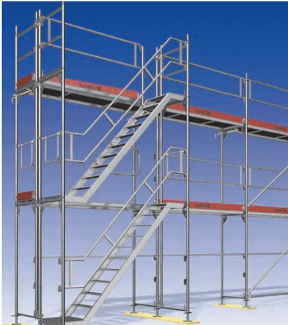
Sowohl im Layher Blitz Gerüst als auch im Layher AllroundGerüst verwendbar. Der vorgesezte Podesttreppenturm ist in der Regelausführung (bis 24 m) in den Blitz-Zulassungen als Gerüstaufstieg enthalten; d. h. bei der geforderten Belastung von 1,0 kN/m<sup>2</sup> sind keine weiteren Nachweise erforderlich. Maximale Aufbauhöhe: 40 m nach Statik. Zulässige Belastung der Podesttreppe: 2,5 kN/m<sup>2</sup>.
