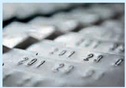
Genauso selbstverständlich wie strenge Qualitätskontrollen in jeder Produktionsphase ist für uns die Kennzeichnung und Dokumentation aller Teile. So erhält zum Beispiel jeder Layher Boden am Ende des Produktionsprozesses eine Prägung, die Auskunft über Maschine, Herstellungstag und verschiedene Produktionsparameter gibt.
