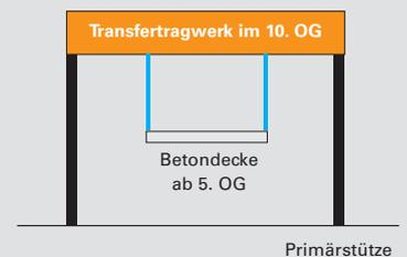
Am Ende der Bauarbeiten werden die freihängenden Decken in die Stahlkonstruktion (Transfertragwerk) im 10. OG eingehängt und so das Traggerüst entlastet.
